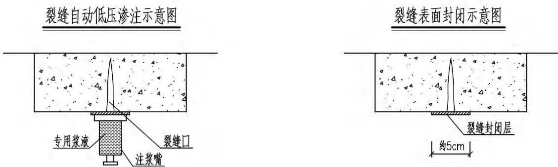
混凝土裂缝封闭示意图
