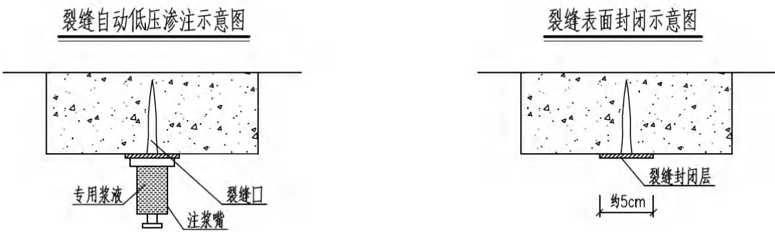
混凝土裂缝封闭示意图
