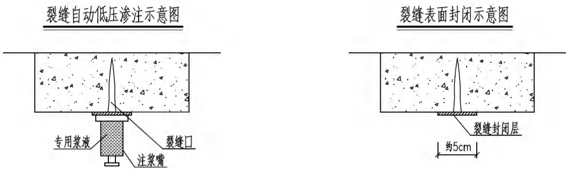
混凝土裂缝封闭示意图
