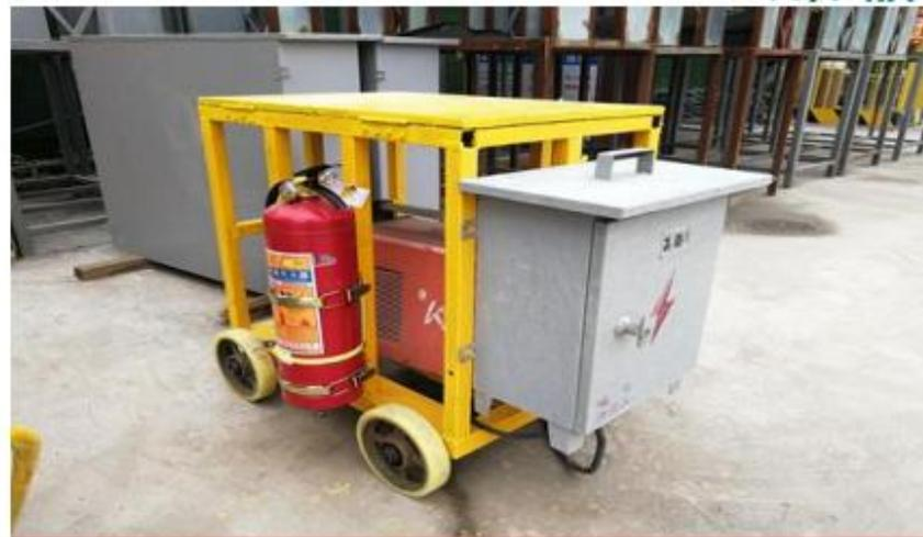
焊机灭火器，开关箱、防雨淋
