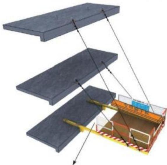
此处为脚手架空档，使用时应张挂安全平网，并于平网上部铺设专用防滑脚手板，随楼层层转使用。
